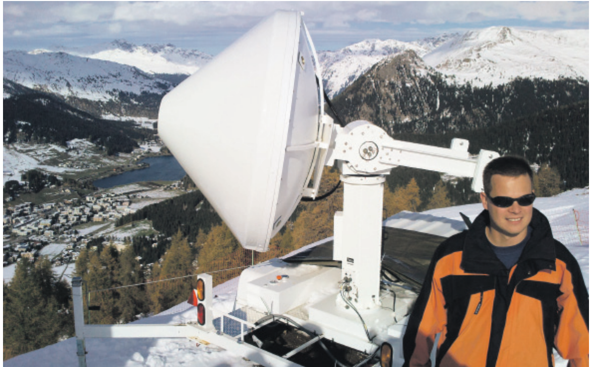
Alexis Berne explique le fonctionnement du radar au pied du Jakobshorn
